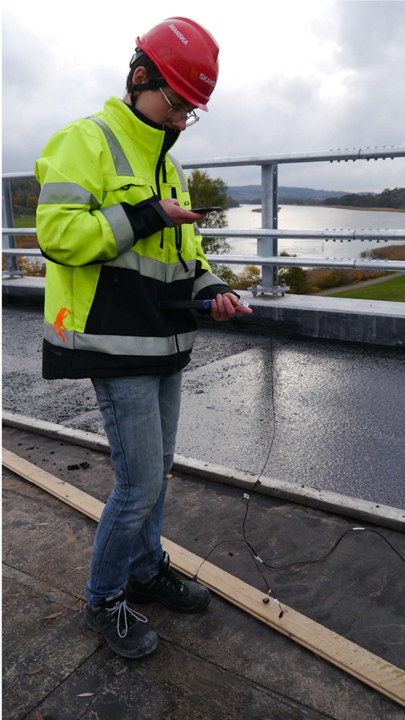
Bild 50, Uppföljning av temperaturmätningar under avsvälningen.
