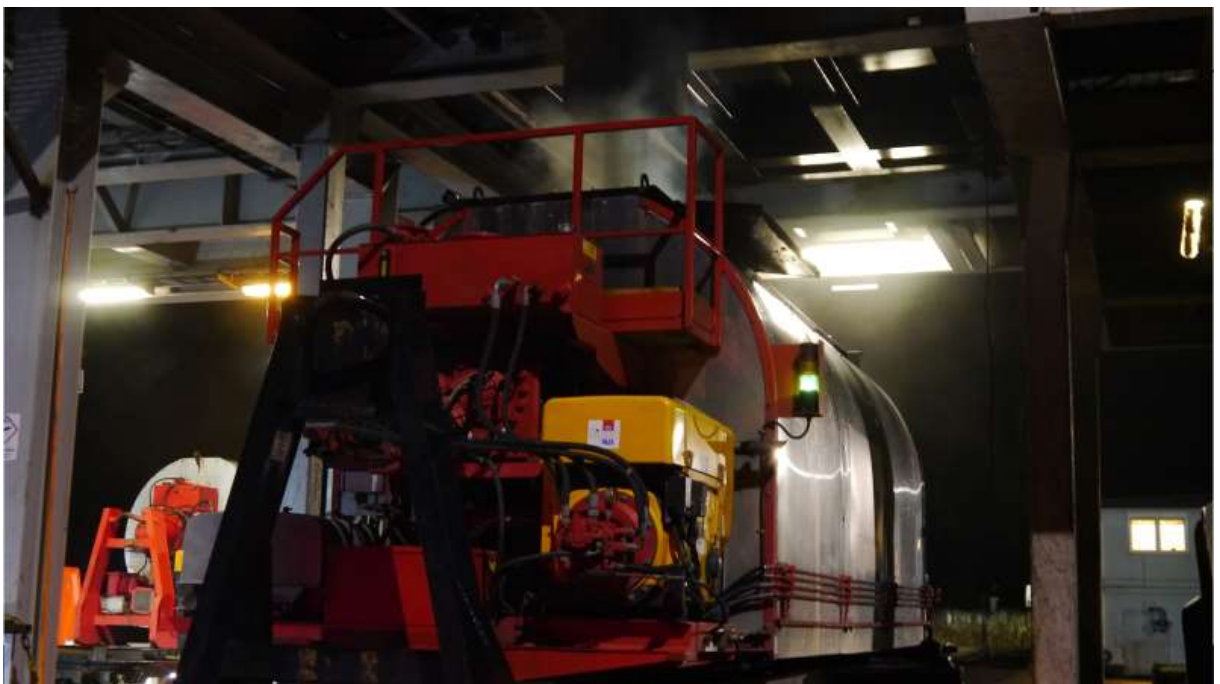
Bild 33, Gjutasfaltbil som lastas inför transport till arbetsplatsen.
