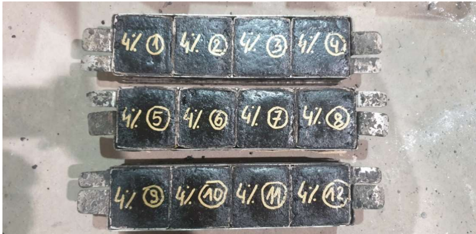
Blid 7: Gjutasfaltskuber, efter tillverkning utförd på Skanska Sveriges laboratorium i Västerhaninge, 2020.
