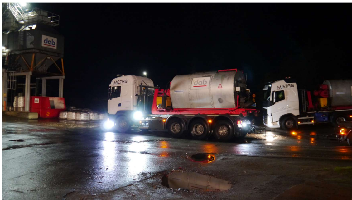
Bild 31, Gjutasfaltbilar ska lastas inför transport till arbetsplatsen.
