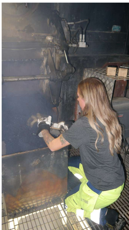
Bild 34 och 35, Uttagning av prov på gjutasfaltblandningarna på verk.
