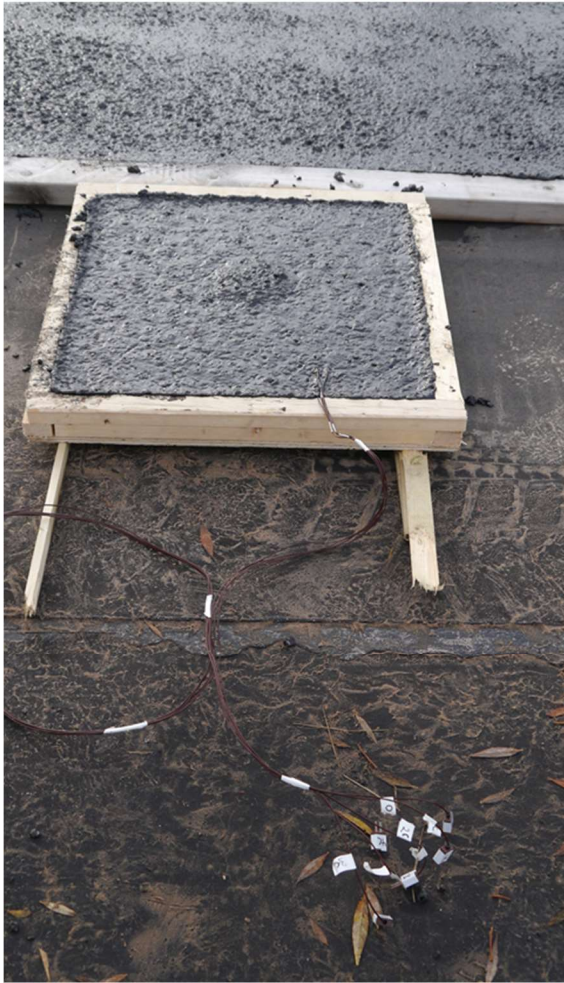
Bild 47-48, Temperaturmätning av gjutasfalt med magnetit på E6 Nordreälvbron
