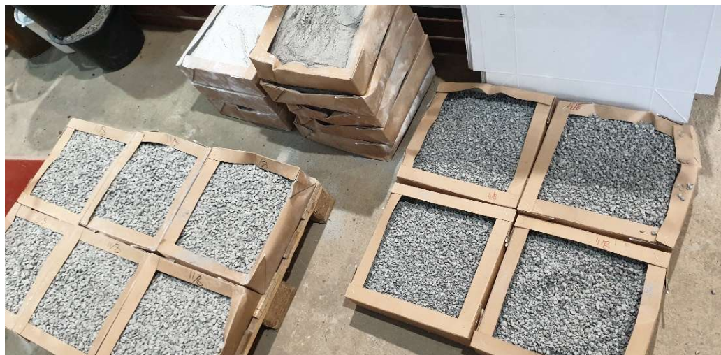
Bild 1: Stenmaterial och filler, som användes vid laboratorieblandningarna på Skanska Sveriges laboratorium i Västerhaninge, 2020.
