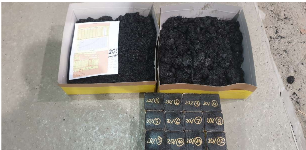
Bild 8: Gjutasaltsprover, 12st och resterande gjutasfalt efter blandning, utförd på Skanska Sveriges laboratorium i Västerhaninge, 2020.
