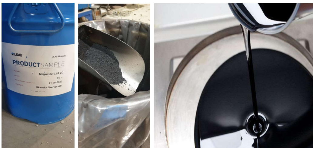
Bild 2, 3 och 4: Magnetitfiller och bitumen, som användes vid blandningarna på Skanska Sveriges laboratorium i Västerhaninge, 2020.
