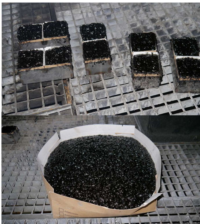
Bild 34 och 35, Uttagning av prov på gjutasfaltblandningarna på verk.
