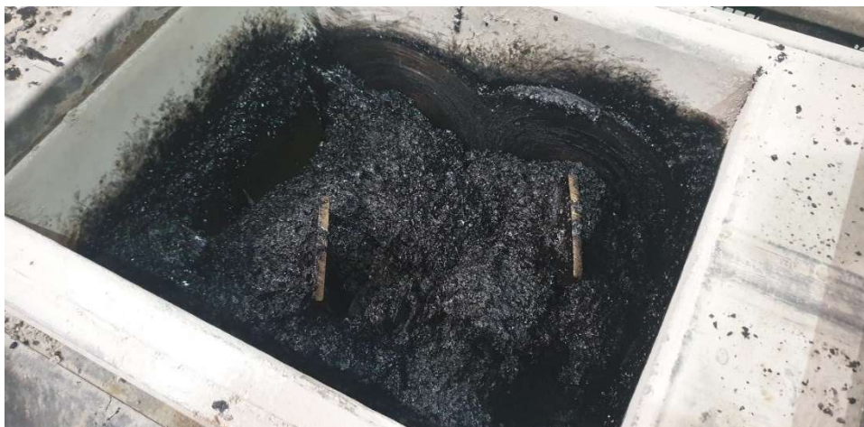
Bild 6: Färdigblandad gjutasfaltsmassa, efter 2 timmar blandningstid, på Skanska Sveriges laboratorium i Västerhaninge, 2020.
